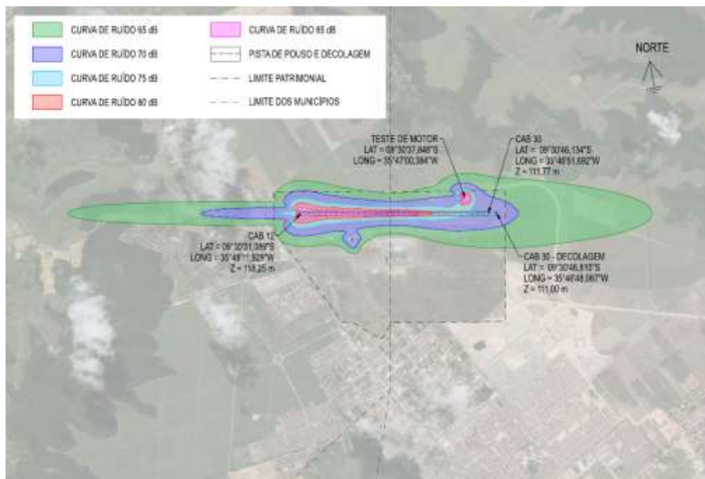
Figura 7-2: Curvas de Ruído Obtida - Horizonte Final de Planejamento
