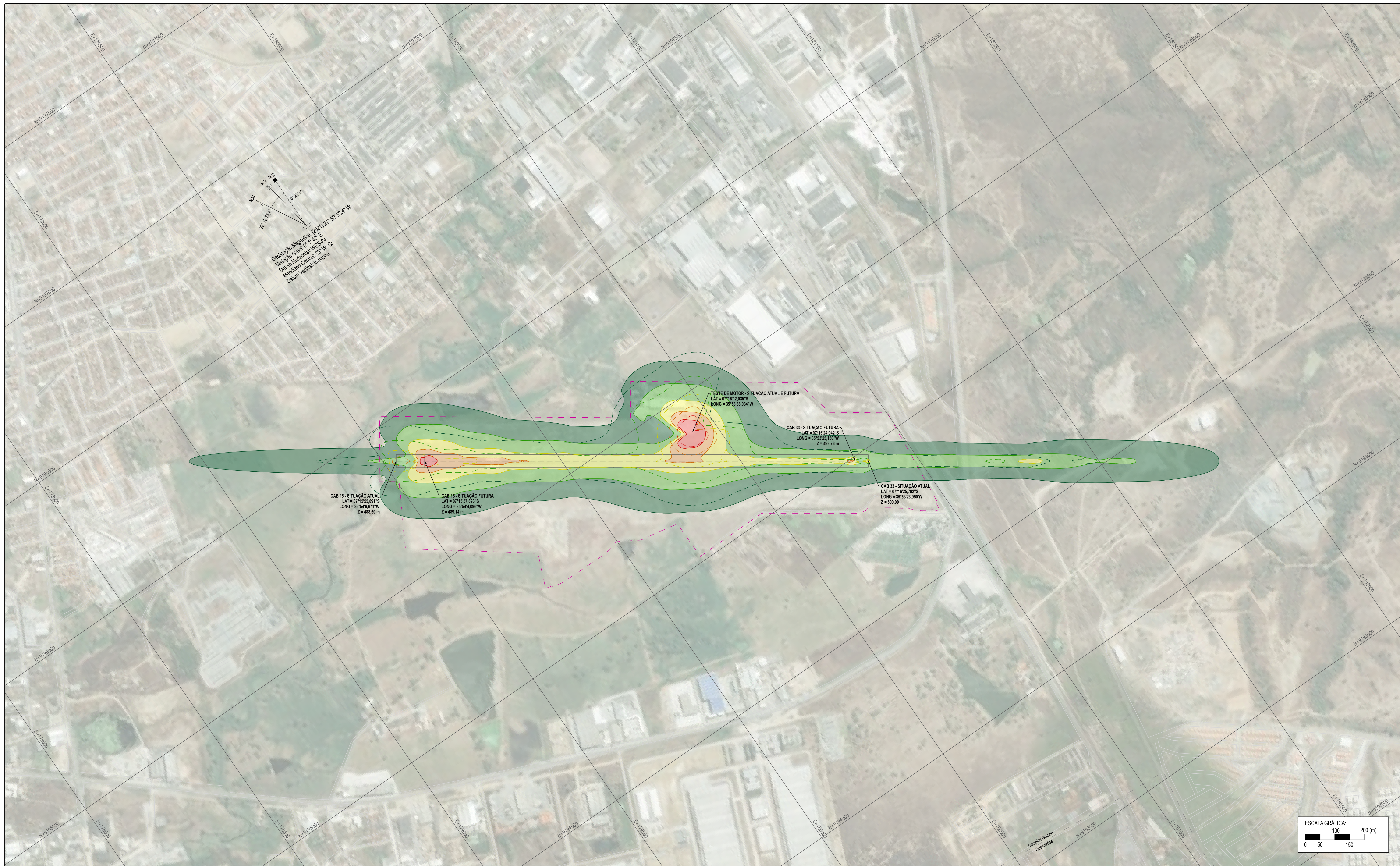
PEZR - PLANO ESPECÍFICO DE ZONEAMENTO DE RUÍDO - SOBREPOSIÇÃO DAS CURVAS DE RUÍDO DA SITUAÇÃO ATUAL E SITUAÇÃO FUTURA ESC. 1:5.000
